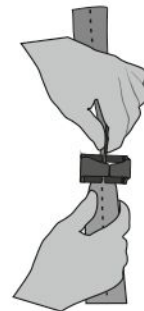
Рис. 4. Проведение ленты привязи
