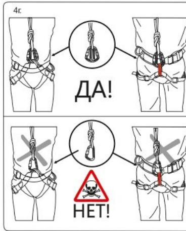
Рис. 5. Подключение страховочных устройств
