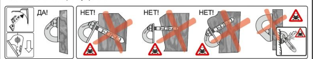
Рис. 5. Расположение анкерного устройства
