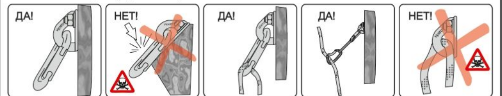
Рис. 6. Положение анкерного устройства и карабина
